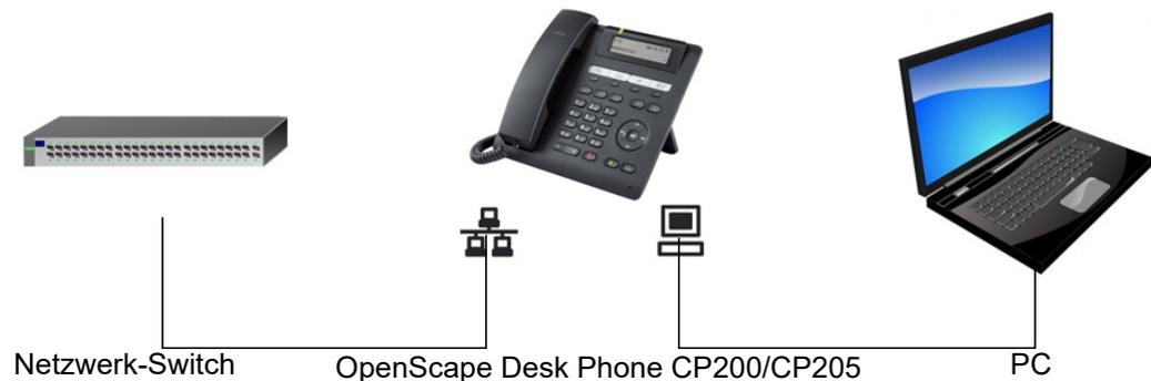
Durch diese Anschlussart sparen Sie jeweils einen Netzwerk-Anschluss des verwendeten Switches und nutzen bei entsprechender Anordnung kürzere Leitungswege.
