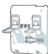
4. Se la vostra LAN non è dotata di PoE (Power over Ethernet) - chiedere al personale tecnico incaricato - collegate alla presa **C** un alimentatore omologato.
