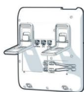
4. Wenn Ihr LAN nicht über PoE (Power over Ethernet) verfügt (zuständiges Fachpersonal fragen), schließen Sie ein zugelassenes Netzgerät an der Buchse **C**
