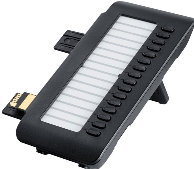
OpenScape Key Module 400 wird in der obigen Abbildung gezeigt. Sie können bis zu 2 zusätzliche OpenScape Key Module 400 anschließen. Wenn Sie ein zweites Beistellgerät anschließen möchten, ist eine externe Stromversorgung erforderlich.
