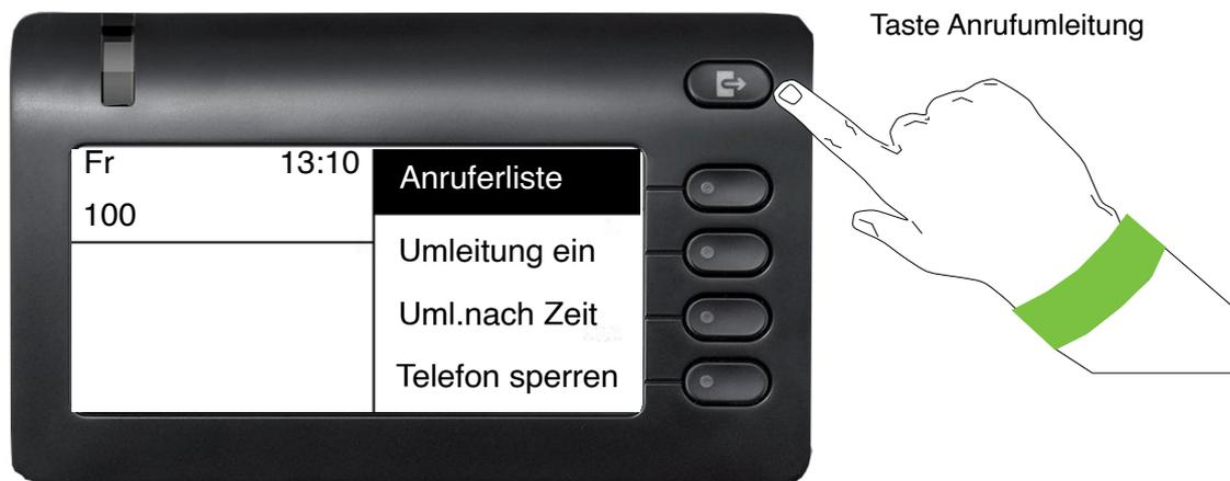
Um zum Menü „Anrufumleitung“ zu gelangen, drücken Sie die Taste Anrufumleitung
