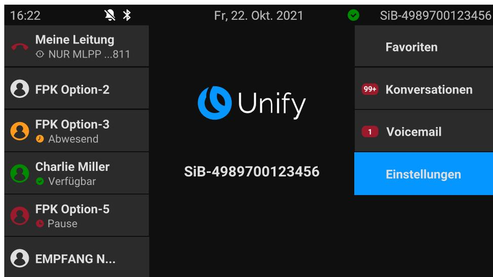
Das Hauptmenü bietet zusätzliche Funktionen und ist der Ausgangspunkt für den Menübaum. Da die Telefonie-Funktionen an einem Telefon jedoch Vorrang haben, ist der Landebildschirm möglicherweise die Konversationsliste oder die Anzeige, die Sie konfiguriert haben.
