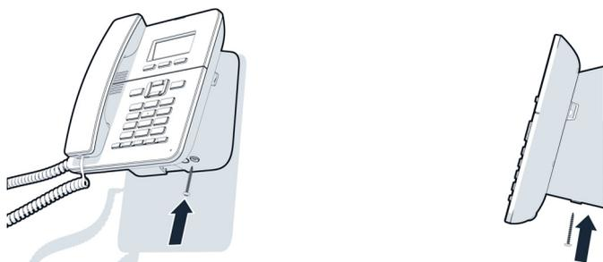
Als letztes setzen Sie bitte die lange Sicherungsschraube am unteren Ende des Adapters ein.
