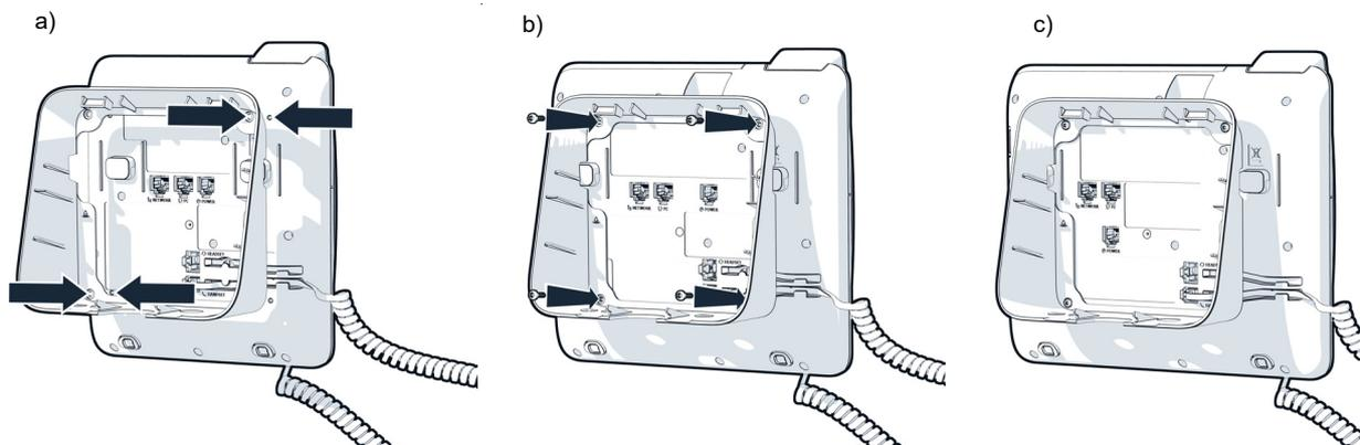
Legen Sie die Wandmontage-Adapter auf die Rückseite des Telefons und richten Sie diesen nach den Löchern im Telefon aus.
