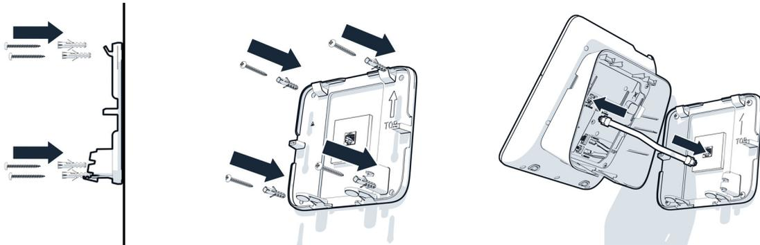
Positionieren Sie die Wandhalterung an der Wand und kennzeichnen Sie die Bohrlöcher.
