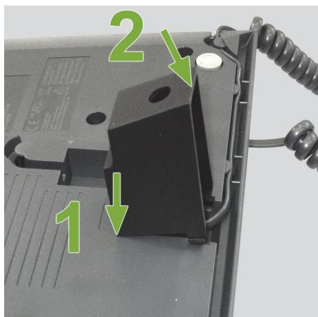
Montieren Sie den Abstandshalter am Telefon über den Hörerkabelanschluss. Die seitlichen Haken rasten einfach ein, wenn Sie den Abstandshalter dabei etwas zusammen drücken.
