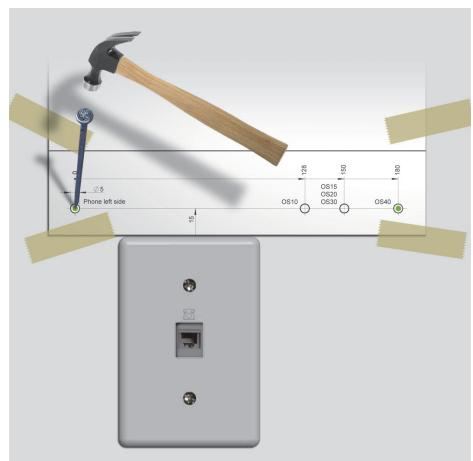
Körnen Sie die Position der zwei zum Telefon passenden Löcher mittels Bohrschablone an und entfernen Sie die Bohrschablone. Weiter mit Schritt 7 auf der Rückseite →
