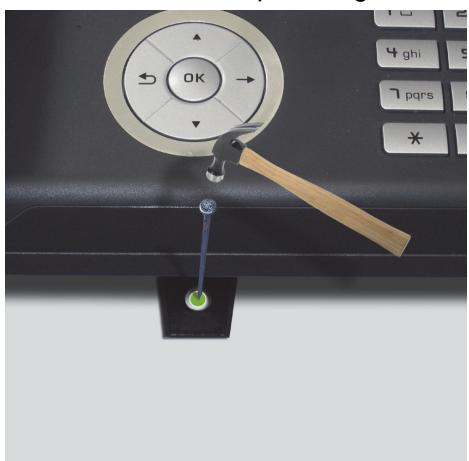
Körnen Sie die Position der dritten Bohrung mittels Abstandshalter an und hängen Sie das Telefon wieder ab.
