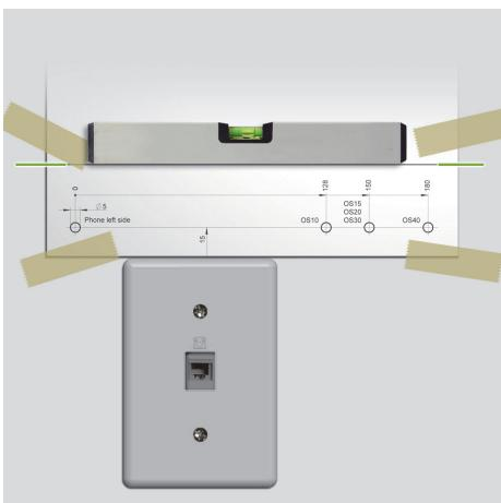
Richten Sie die Bohrlehre (siehe unten auf dieser Seite) anhand der Telefondose oder mit einer Wasserwaage aus und kleben Sie diese mit Klebestreifen an die Wand. Rechts und links von den Bohrungen wird mind. 50 mm Platz benötigt.
