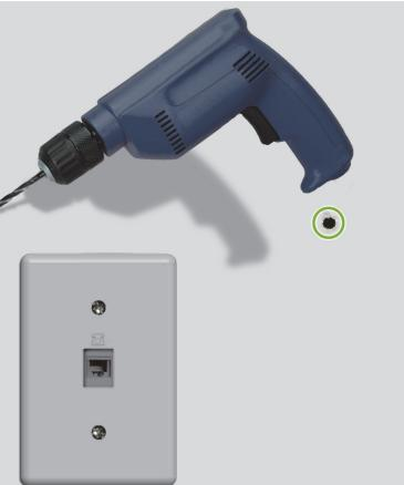
Bohren Sie die angekörnten Löcher. Setzen Sie abhängig von der Beschaffenheit der Wand passende Dübel ein.
