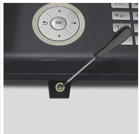
Verbinden Sie die Anschlusskabel mit dem Telefon. Hängen Sie das Telefon ein und schrauben Sie dieses mit einer Schraube und Scheibe an.
