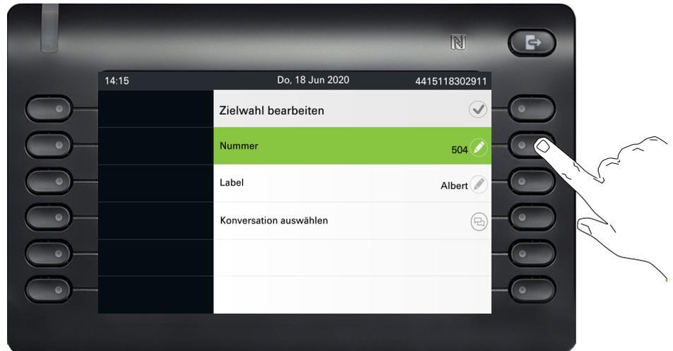
Sie werden zum Bildschirm „Zielwahl bearbeiten“ zurückgeleitet, wo unter „Rufnummer“ nun die Standardnummer oder die gewählte Nummer des Kontakts und unter „Bezeichnung“ der Name des Kontakts angezeigt wird.
