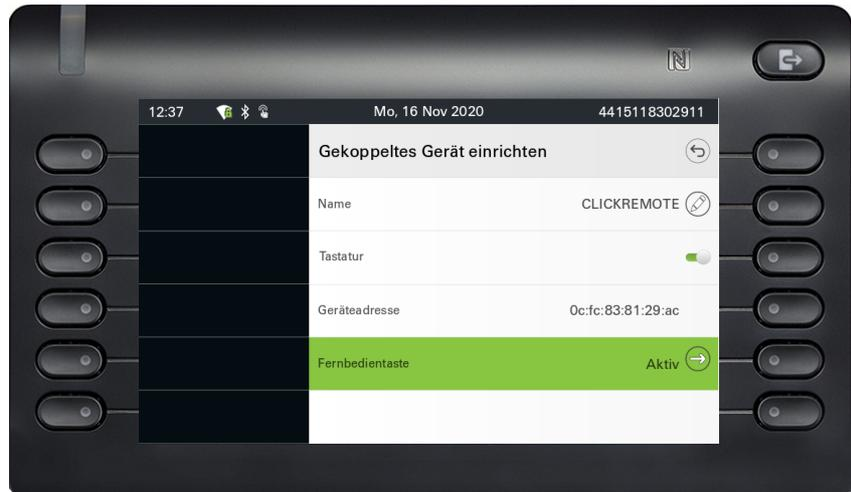
Die Auswahl des obigen Menüs "Fernbedienungstaste" führt zu dem Bildschirm, auf dem dieses Bluetooth-Fernbedienungsgerät (genannt Selfie) konfiguriert werden kann. Die Funktionstasten sind durch ihre Tastenbeschriftung im Bildschirm "Taste auswählen" gekennzeichnet.
