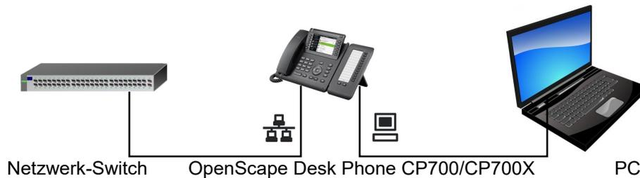
Durch diese Anschlussart sparen Sie einen Netzwerk-Anschluss des verwendeten Switches und nutzen kürzere Leitungswege.
