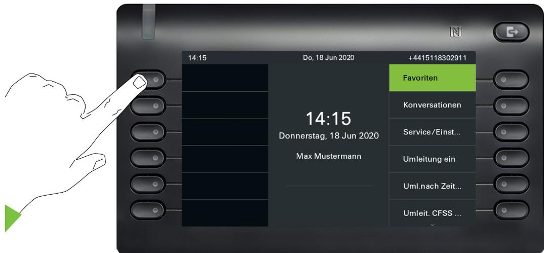
Halten Sie die Taste im linken Bedienfeld, die Sie mit einer Funktion belegen wollen, z. B. Zweit-anruf ein-/ausschalten (Anklopfen), so lange gedrückt, bis die Programmieraufforderung angezeigt wird.
