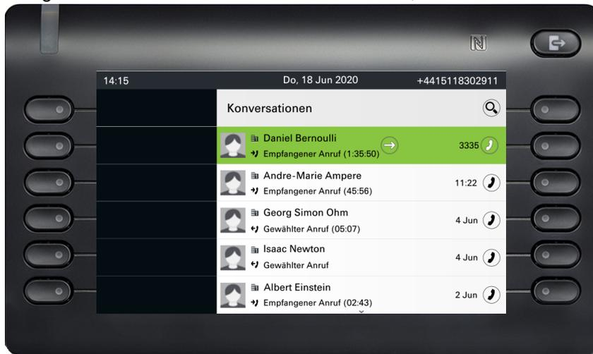
Wählen Sie die Kopfzeile der Konversationsliste mit der Taste
