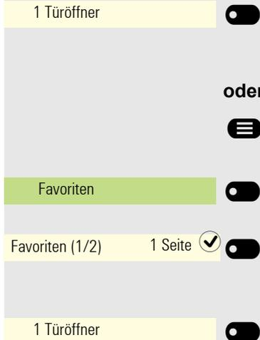
Drücken Sie die Funktionstaste im linken Bedienfeld oder an einem angeschlossenen OpenScape Key Module 600, der die Funktion Türöffner zugewiesen wurde.
