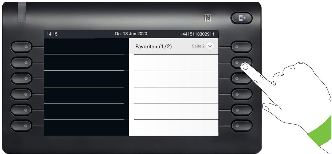
Drücken Sie den zweiten Softkey lange, um die erste Funktionstaste auf Seite 2 zu belegen.
