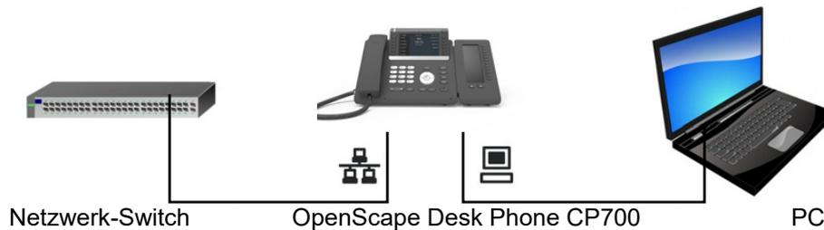
Durch diese Anschlussart sparen Sie einen Netzwerkanschluss für den verwendeten Switch und benötigen weniger Netzwerkkabel.
