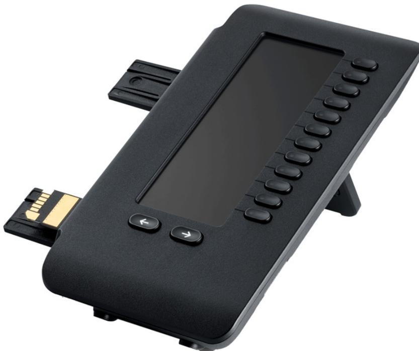
Die Abbildung zeigt das OpenScape Key Module 600. Sie können bis zu zwei OpenScape Key Module 600 an das OpenScape Desk Phone CP700/700X anschließen.
