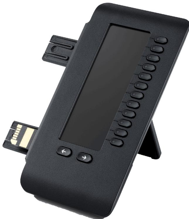
Die Abbildung zeigt das OpenScape Key Module 600. Sie können bis zu zwei OpenScape Key Module 600 an OpenScapeDeskPhoneCP700 und bis zu vier OpenScape Key Module 600 an OpenScape Desk Phone CP700X anschließen.
