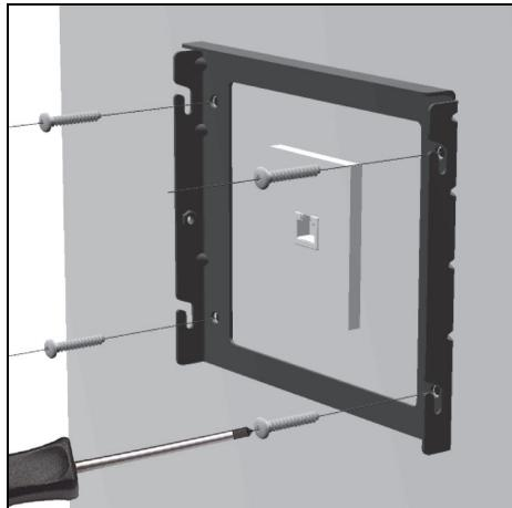
Schrauben Sie die Wandhalterung mit vier Schrauben an die Wand.
