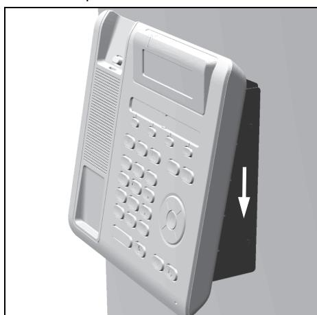
Schieben Sie das Telefon zur Wand, bis die hintere Position erreicht ist.
