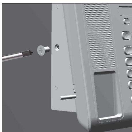
Verschrauben Sie die beiden Rahmen der Wandhalterung auf der linken Seite mithilfe der mitgelieferten Senkschraube.
