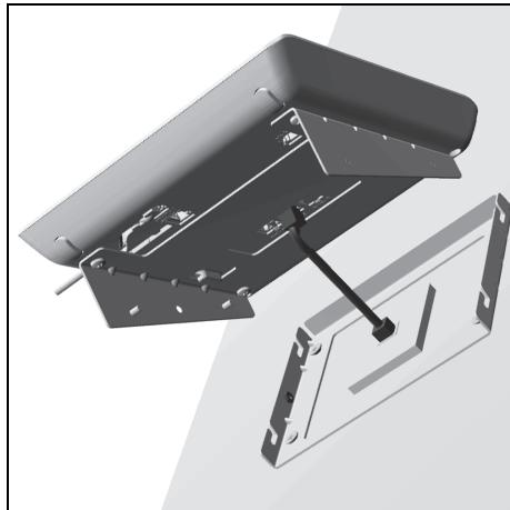
Stecken Sie das Netzwerkkabel in die entsprechende Buchse
