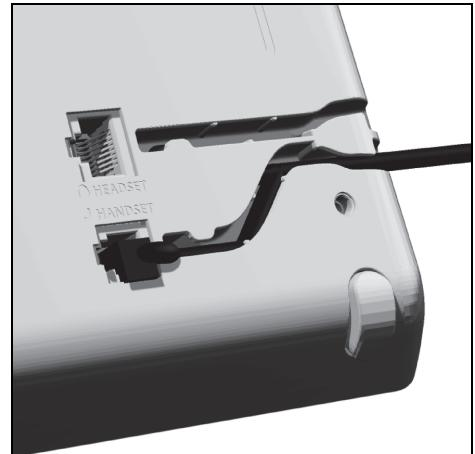
Stecken Sie den Stecker des **langen** geraden Hörerkabelendes in die entsprechende Buchse
