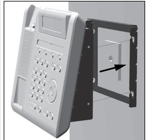
Setzen Sie das Telefon mit vormontiertem Rahmen auf den Rahmen an der Wand, sodass die seitlichen Zapfen des Telefon-Rahmens in die Führung am Wand-Rahmen greifen.
