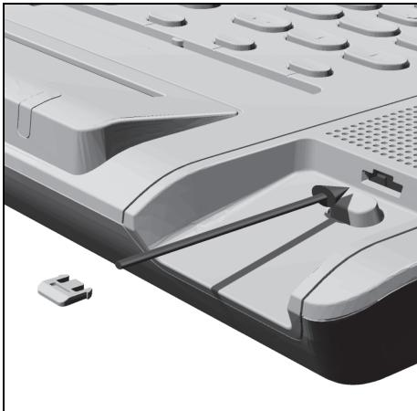
Montieren Sie eine der Hörerklammern mit der **Schräge nach vorne** und mit den **Widerhaken zuerst** in der Ablageschale.
