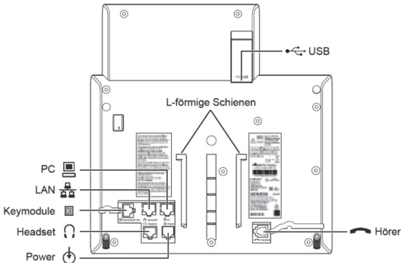
Wenn Ihr LAN nicht über PoE (Power over Ethernet) verfügt (zuständiges Fachpersonal fragen), ist ein Netzgerät erforderlich. Stecken Sie den Stecker des Netzgerätes in die Buchse auf der Unterseite des Telefons.
