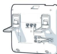
4. Als uw netwerk niet over PoE (Power-over-Ethernet) beschikt (raadpleeg de systeembeheerder), sluit u een goedgekeurde netwerkadapter aan op bus Ⓛ Ⓛ.
