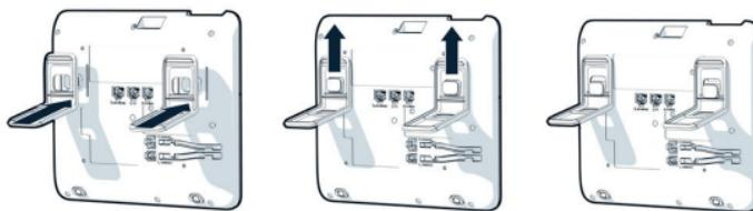
4. Se la vostra LAN non è dotata di PoE (Power over Ethernet) - chiedere al personale tecnico incaricato - collegate alla presa **A** un alimentatore omologato.
