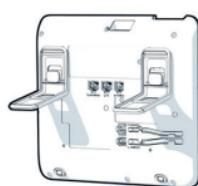
4. Wenn Ihr LAN nicht über PoE (Power over Ethernet) verfügt (zuständiges Fachpersonal fragen), schließen Sie ein zugelassenes Netzgerät an der Buchse **A** an.
