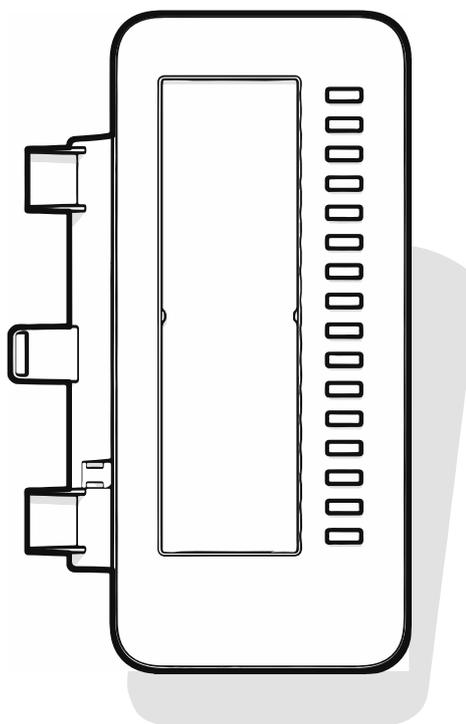
Das KM410 ist ein optionales Tastenmodul, das an der rechten Seite des Telefons angebracht und angeschlossen wird und zusätzliche 16 beleuchtete und
