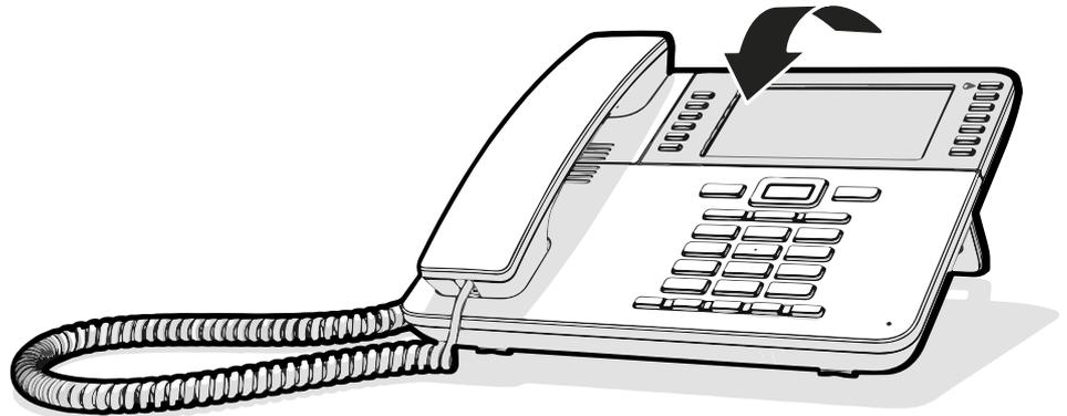
Sie können das Display kippen. Stellen Sie die Displayeinheit so ein, dass sie gut lesbar ist. Das Display rastet in seiner Position ein.
